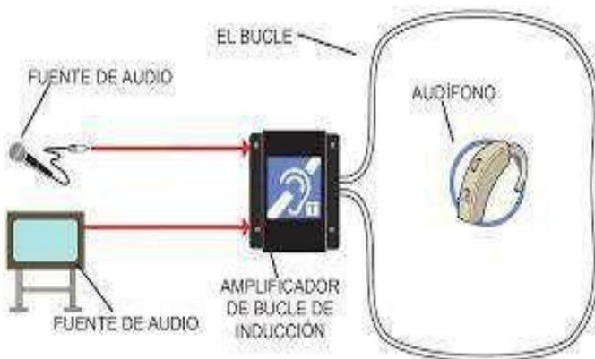
Un Bucle Magnético o de inducción es un sistema de sonido que transforma la señal de audio que todos podemos oír, en un campo magnético captado por los Implantes cocleares y audífonos dotados de posición "T".
